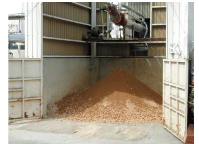
再資源化する乾燥汚泥
