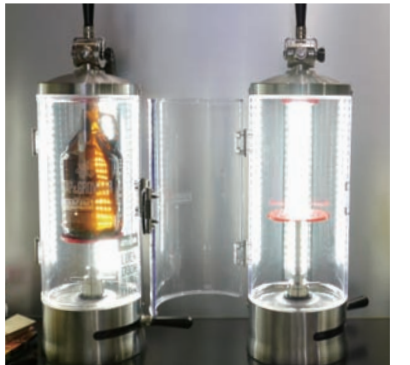
▲日本初の専用充填機は海外製。背景のライトで液面を確認できる
