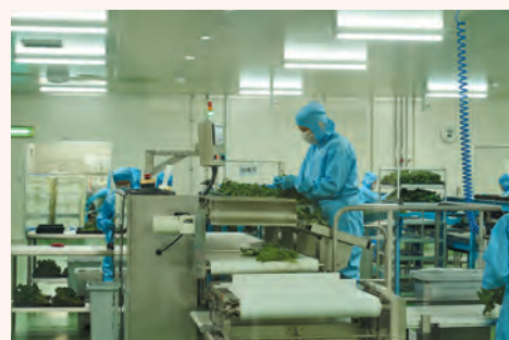
③機械で重さを計量 一袋の重さを規定値に
