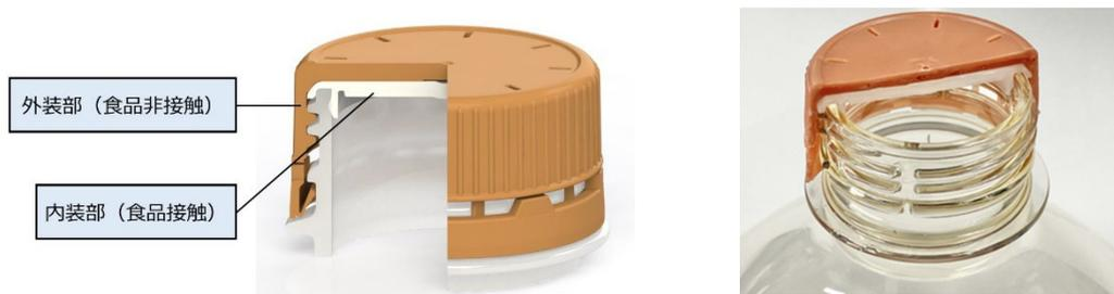
当実証実験で使用するキャップは、「ホームタップ」製品を製造する工程で発生した廃棄キャップをメカニカルリサイクルし、内装部（食品接触）と外装部（食品非接触）の2つに分かれている2ピースキャップの外装部にリサイクル素材を10%混合したものです。中味に直接接触しない外装部のみにリサイクル素材を混合することで、キャップへのメカニカルリサイクル素材の使用を可能としました。当実証実験では、約4万個のキャップを使用します。当実証実験で採用するキャップ1個当たりにつき、GHG（温室効果ガス）排出量を約1.7g削減できる見込みです。
