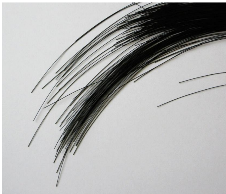
モノフィラメント： PET ボトルキャップを原材料に使用。ポリエチレン、ポリプロピレンそれぞれの素材にて開発
