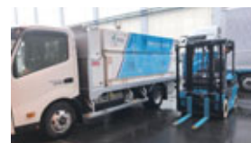
簡易型水素充填車での充填
